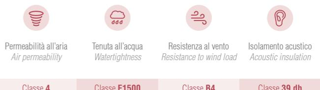
Valori ottenuti per una portafinestra con dimensioni normalizzate secondo UNI EN 14351-1 (3,00m (+25%) x 2,18m (-25%)) con vetrocamera Ug 1,00W/m²K e Psi 0,036.
