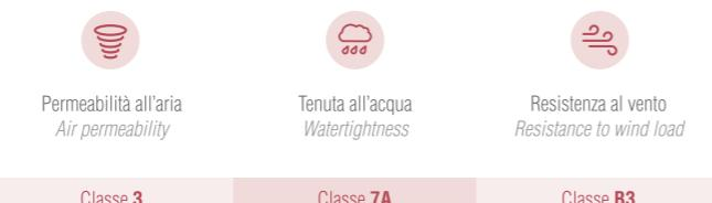
Valori ottenuti per una portafinestra con dimensioni normalizzate secondo UNI EN 14351-1 (1,48m (+25%) x 2,18m (-25%)) con vetrocamera Ug 1,00W/m²K e Psi 0,036.
